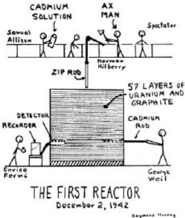
Scram, acronimo di Safety Control Rod Axe Man (uomo ascia alla barra di controllo della sicurezza) indica lo spegnimento del reattore in caso di emergenza. Il disegno del fisico Raymond Murray è riferito al reattore del progetto Manhattan, con Enrico Fermi stilizzato in basso a sinistra e il mitico primo uomo ascia Norman Hilberry. In alto a sinistra. Tratto da Scram di Baracca-Ferrari e dai lavori di Augusto Gandini.
